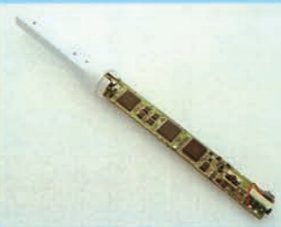
←電車模型への搭載用に製作された超小型CCDカメラ内蔵のトランスコープ。ワイヤレスでの画像送信技術を採用した。
