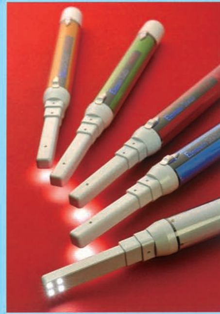
▶デジタルX線センサー「NAOMI」。カーボンカバーの内側には192個の小型CCDが並び、4837万画素の高解像度レントゲン撮影が可能。国内外で広く採用されている。 ↓「アイنشユタイン・ステラ」。世界シェア85%という、ワイヤレス口腔内カメラだ。
