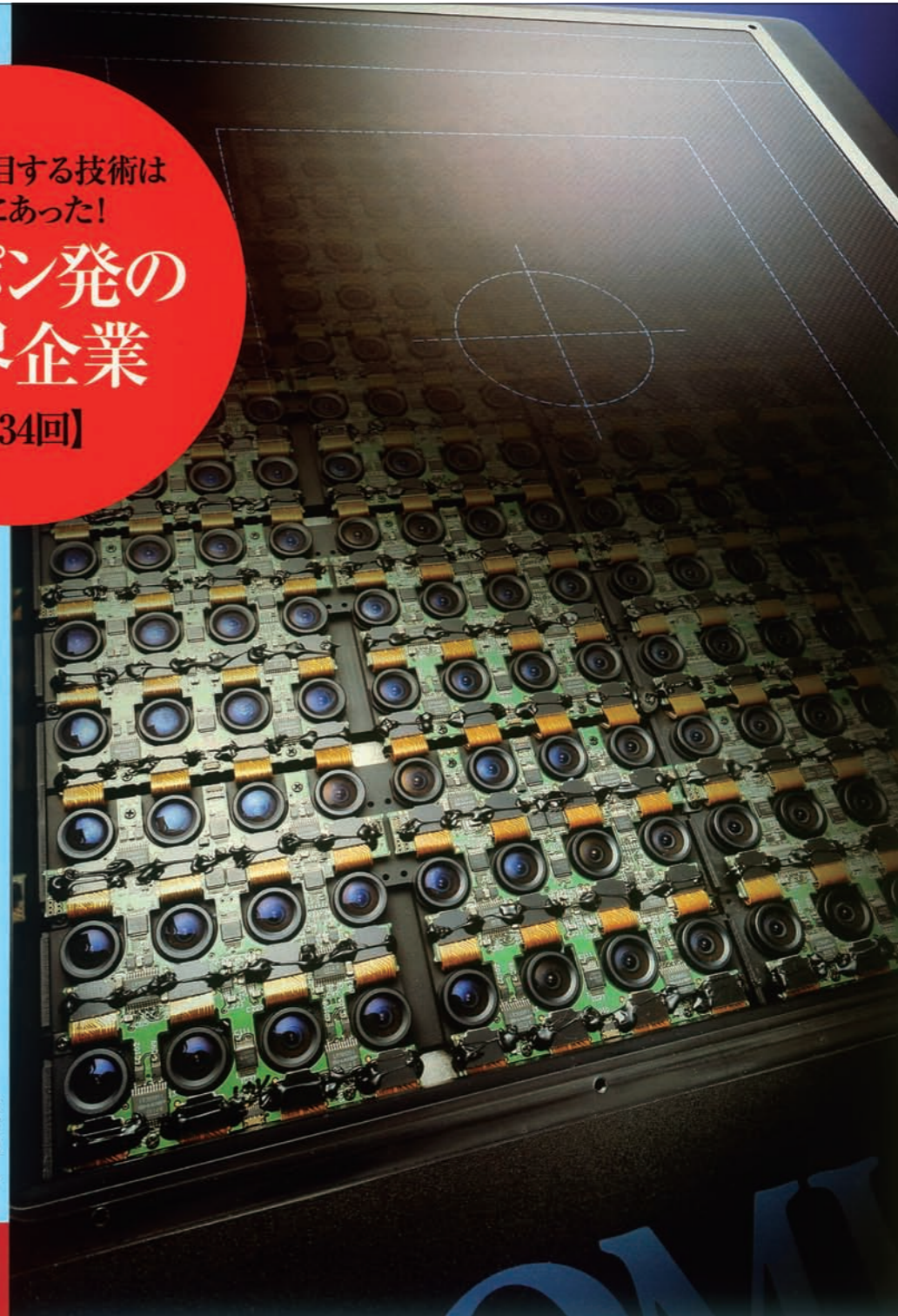
▶デジタルX線センサー「NAOMI」。カーボンカバーの内側には192個の小型CCDが並び、4837万画素の高解像度レントゲン撮影が可能。国内外で広く採用されている。 ↓「アイنشユタイン・ステラ」。世界シェア85%という、ワイヤレス口腔内カメラだ。
