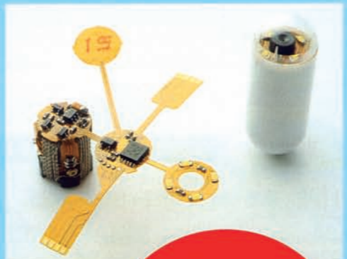
↓デジタルX線センサー「NAOMI」の組み立て。受注に応じて、手作業で組み立てられる。
