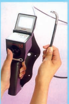
↑ジョイスティックで操作する工業用の先端可動式ビデオ内視鏡。コンパクトな設計で、これ一台で撮影・画像保存が可能だ。
